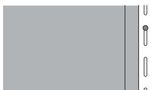
Ajuste en la parte superior de la ranura de clavos sin obstrucciones más alta en el panel hacia la parte superior de la pared. NO lo ajuste a través de bridas de clavado ni de ningún otro accesorio.
